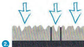
Die Oberfläche von Betonsteinen, die mit einem Hochdruckreiniger bearbeitet wurden, erscheint unter dem Mikroskop als stark aufgeraut.
